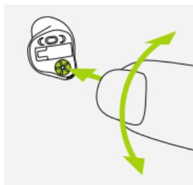
Modèles avec cette option uniquement : pour augmenter le volume sonore, tournez le contrôle de volume vers l'avant. Pour diminuer le volume sonore, tournez le contrôle de volume vers l'arrière.
